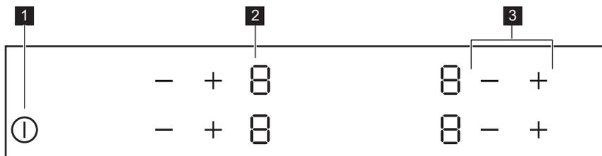
K ovládání spotřebiče použijte senzorová tlačítka. Displeje, ukazatele a zvukové signály signalizují, jaké funkce jsou zapnuté.
